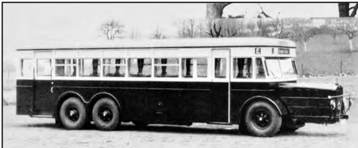
Lo 10000, dreiachsiger Bus mit einem 150 PS starken Sechszylinder-Dieselmotor (1936)
